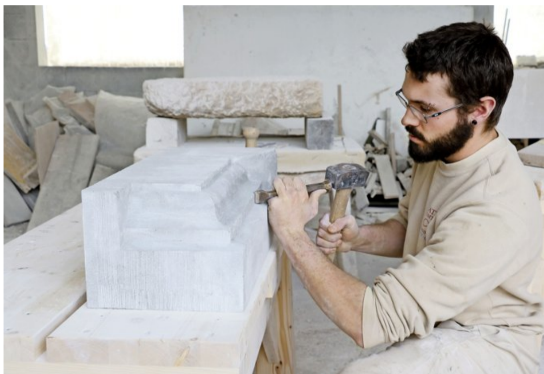
Bertrand Muller, apprenti tailleur de pierre de 4 e année, façonne la mouleure d'une main courante de balustrade. REGULA ECKERT/OFPC-SISP
